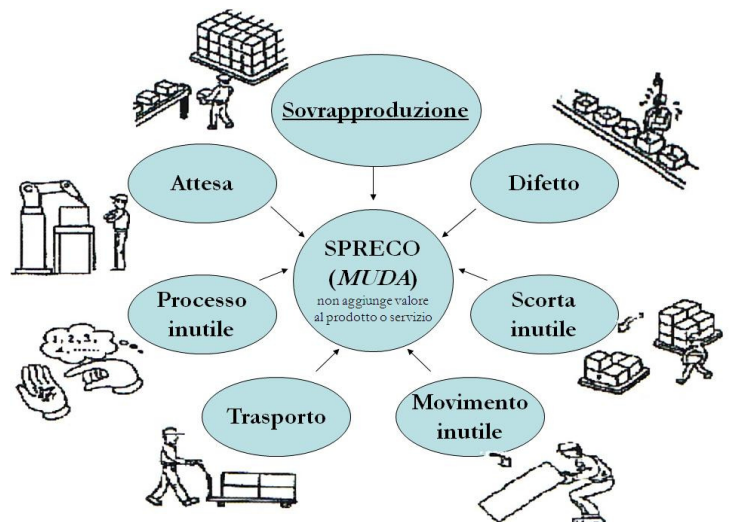
Figura 2.1: I sette tipi di spreco (immagini tratte da Metodi e strumenti per il Fiat Auto Production System , Fiat Group Automobiles, 2007)
